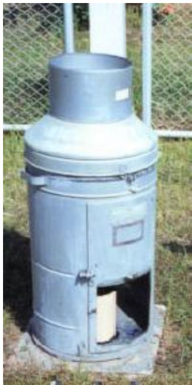
รูปที่ 2.18 เครื่องวัดน้ำฝนแบบชั่งน้ำหนัก (weighing gauge)
