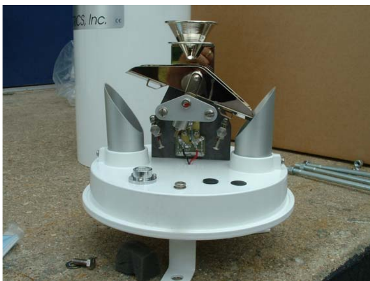
รูปที่ 2.16 เครื่องวัดน้ำฝนแบบถังกระดก (tipping bucket gauge)
