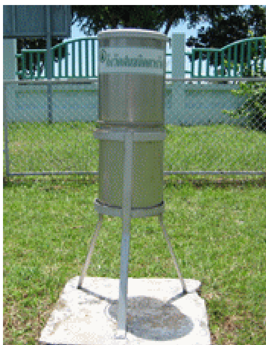
รูปที่ 2.15 เครื่องวัดน้ำฝนแบบธรรมดาหรือแบบแก้วดวง
