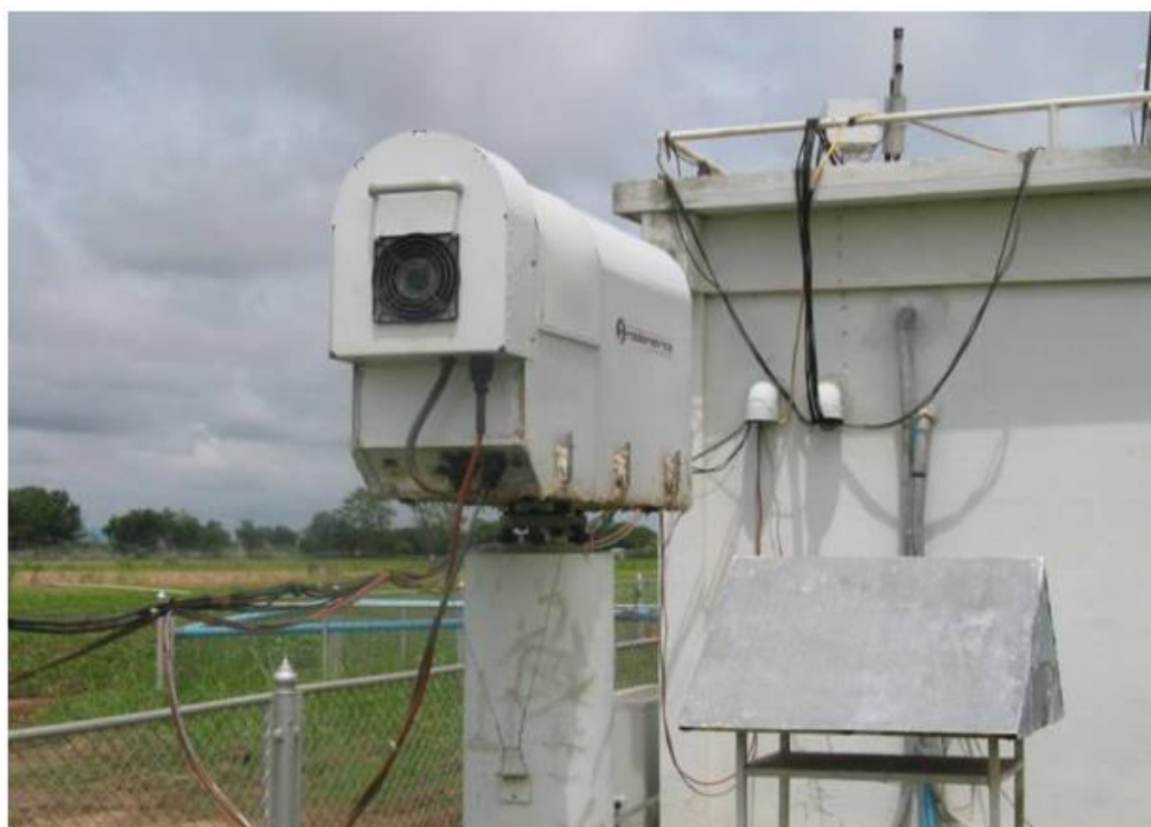
ภาพที่ 2-2 เครื่อง Microwave Radiometer (MWR) ณ สถานีเรดาร์ฝนหลวงพิมาย อ.พิมาย จ.นครราชสีมา (Nithiwatthn Choosakul, 2005)
