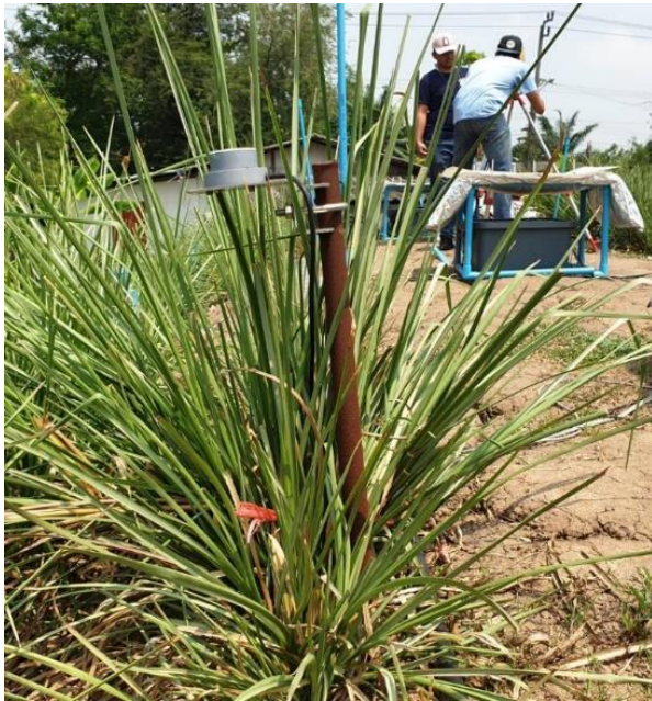
รูปที่ 24. การติดตั้งเครื่องวัดความเอียงที่คันดิน และการคำนวณการเคลื่อนตัวในแนวตั้งและราบ
